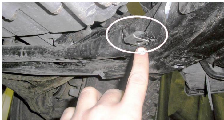
Крепление передней части защиты Скоба устанавливается на место “клопа” пыльника.
