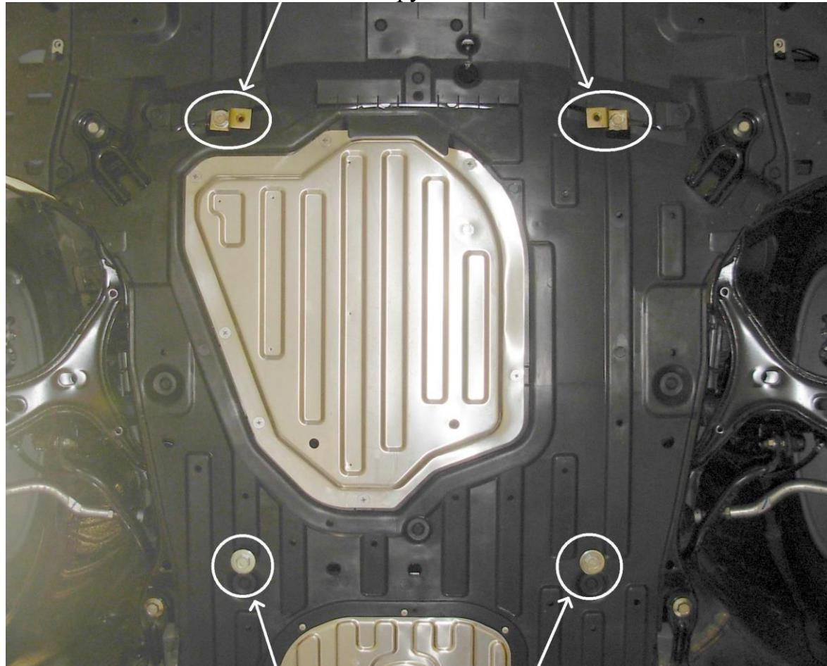
Для крепления задней части защиты необходимо сделать вырезы в пыльнике напротив штатных резьбовых отверстий. Между защитой и подрамником устанавливается проставка 8x22.
