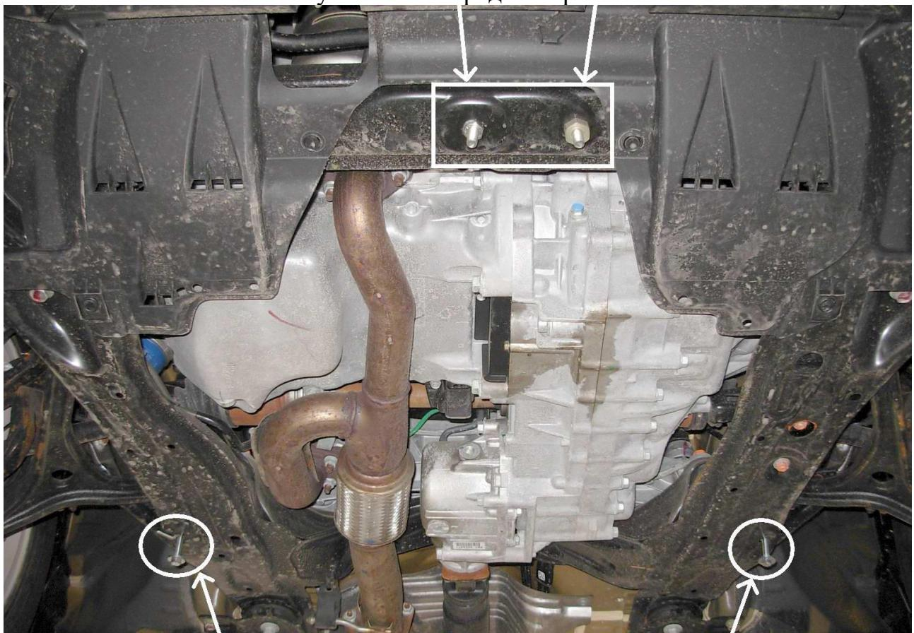
Места установки задних креплений. Пластины устанавливаются прутком вперед.
