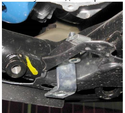
Передние кронштейны устанавливаются в глубокие отштамповки пыльника.
