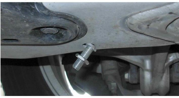
Установить заднюю шпильку и зафиксировать ее низкой гайкой. Низкую гайку не затягивать до упора для простого попадания в крепежное отверстие защиты.
