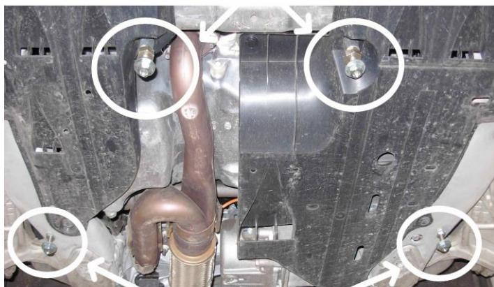
После установки передних креплений, при необходимости, подогнать их рукой для попадания в крепежное отверстие защиты. Средний «клоп» установить обратно.
