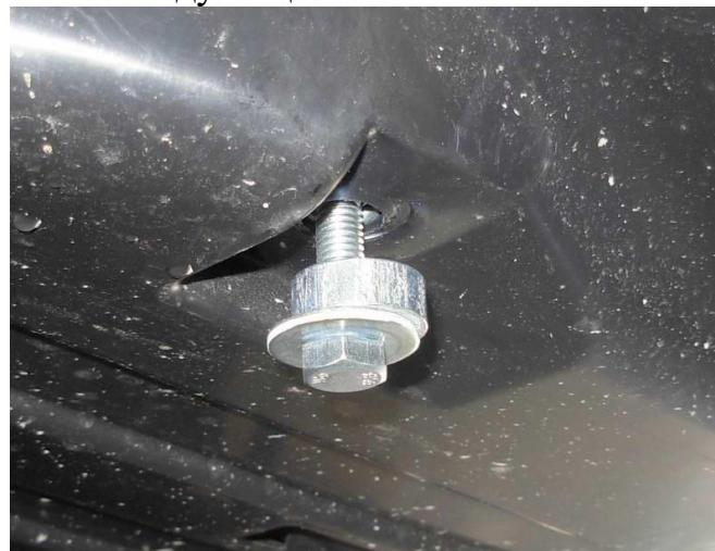
Задняя часть защиты на автомобиле.
