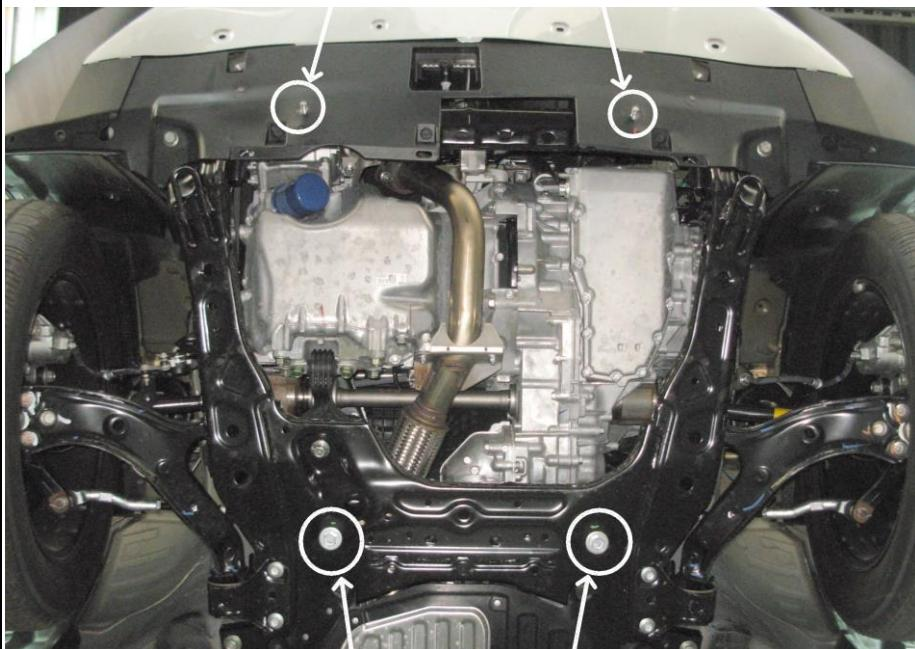
Задняя часть защиты крепится через проставки в штатные резьбовые отверстия.
