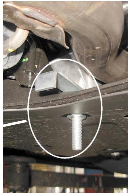
Для установки задних креплений демонтировать металлический тепловой экран, установить крепления, зафиксировать их низкими гайками и вернуть экран на место.
