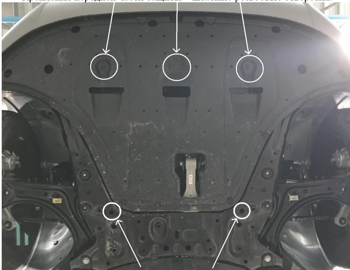
Места установки креплений задней части защиты.
