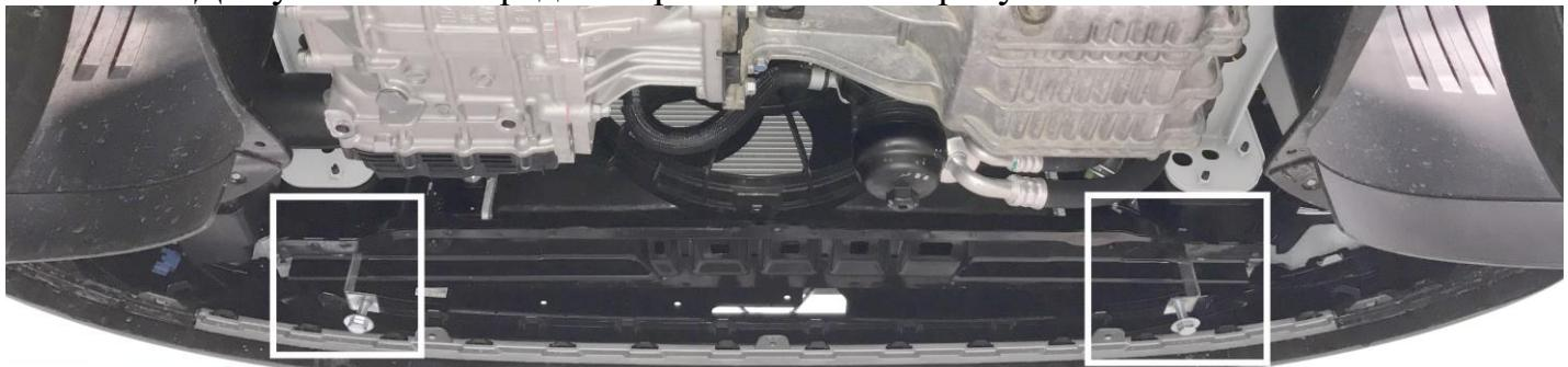
Для совпадения крепежных отверстий кронштейны должны быть ориентированы как показано на схеме (поперек автомобиля) и сведены друг к другу, после чего обтянуты.
