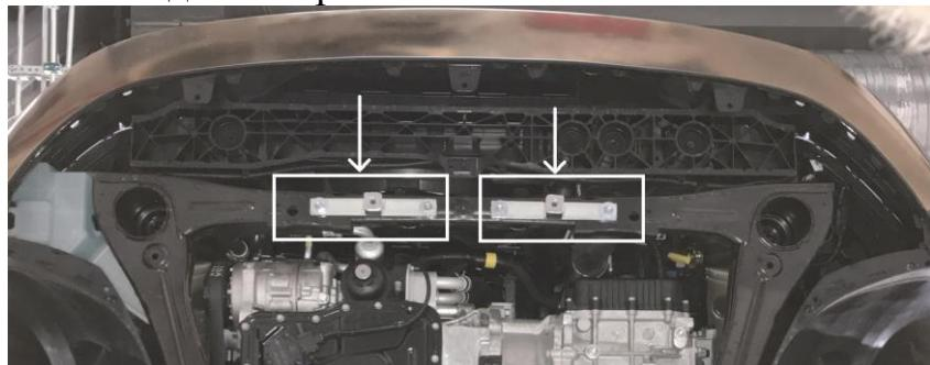
После установки и обтяжки кронштейнов вернуть пыльник на место и сделать в нем квадратные вырезы (примерно, как на фото).
