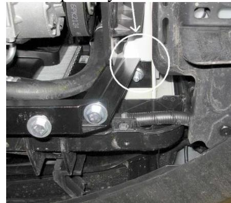
На автомобиле Kia Sorento'12 передняя кромка защиты заводится между бампером и радиатором.
