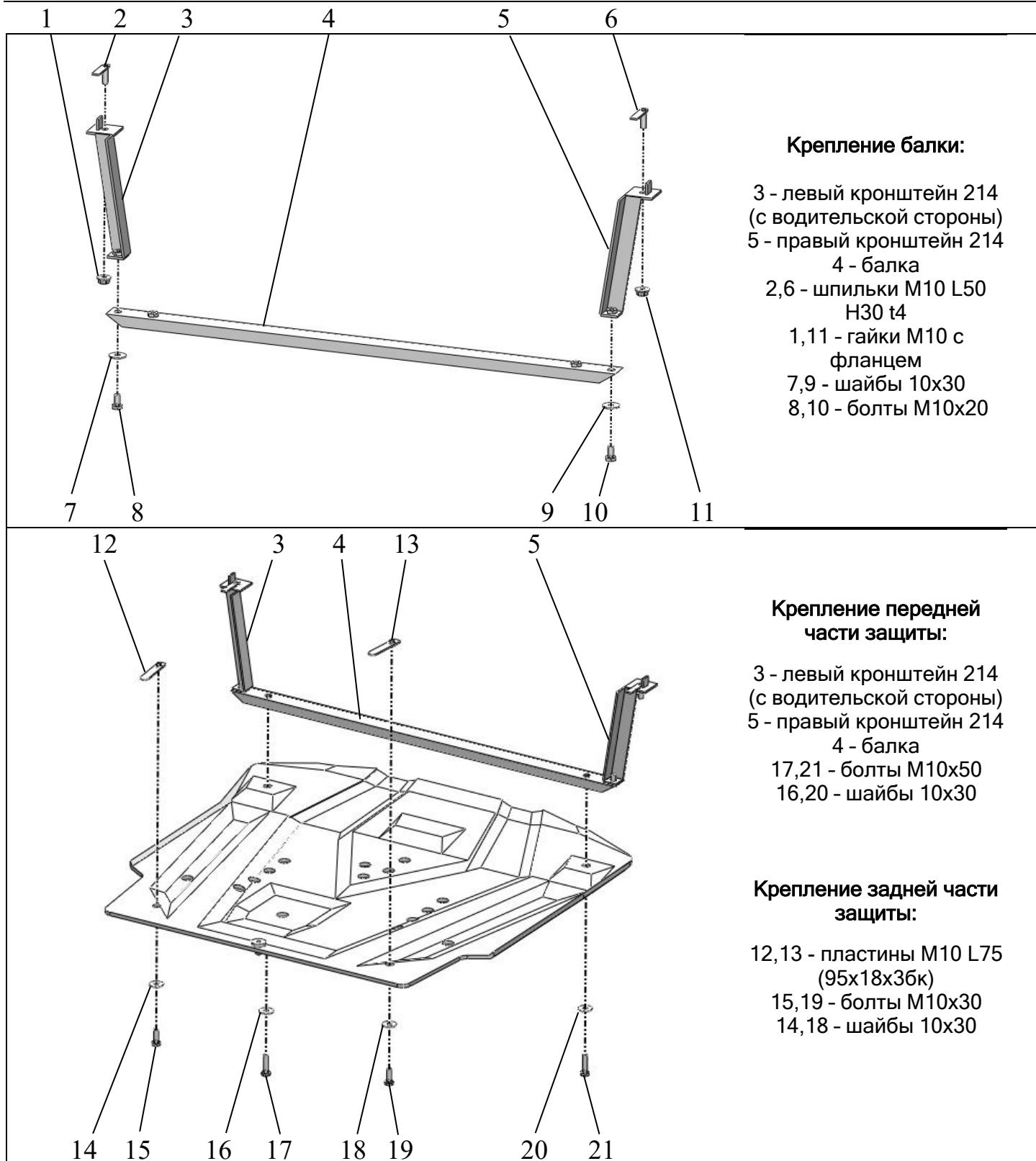
**Момент затяжки резьбовых соединений М10 не более 2,5 кг · м**
