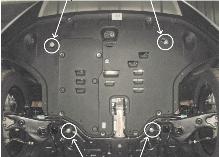
Места установки креплений задней части защиты.
