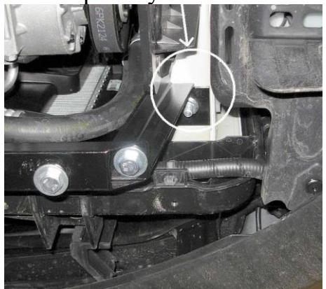
Задняя часть защиты на автомобиле.
