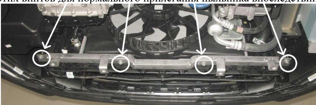
В пыльнике сделать 4 выреза для крепления передней части защиты и вырез под центральную часть балки. Вернуть пыльник на место.
