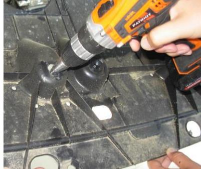
В пыльнике сделать вырезы в тех местах где он упирается в балку. Вернуть пыльник на место. Места установки передних креплений.
