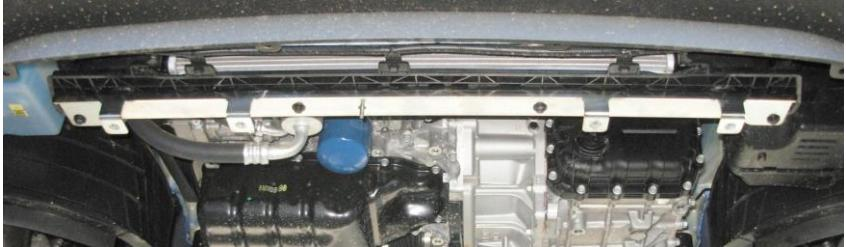
Отверстия в пыльнике расширить напротив этих винтов для нормального прилегания пыльника впоследствии.
