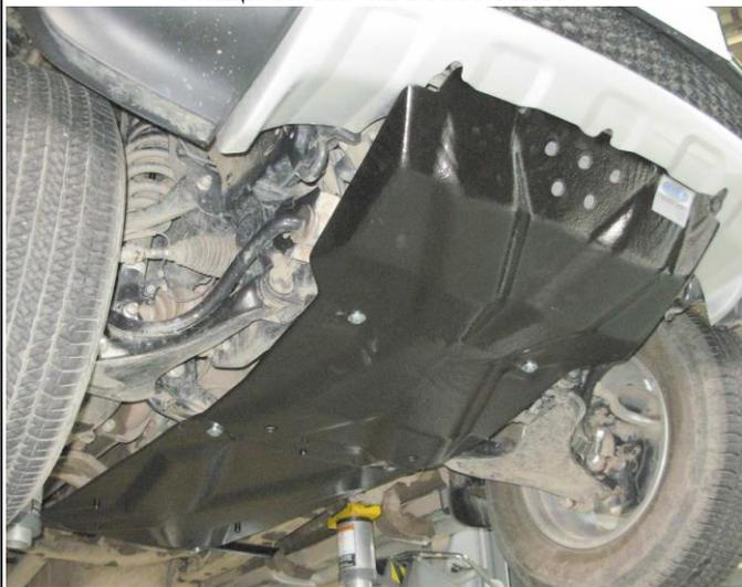
Кронштейны крепятся к раме автомобиля в сборе с пластинами.
