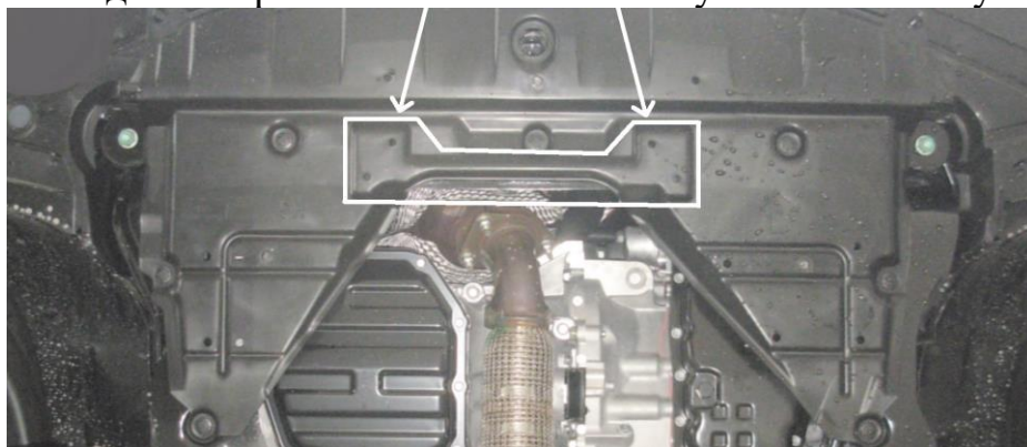
Места установки передних креплений.
